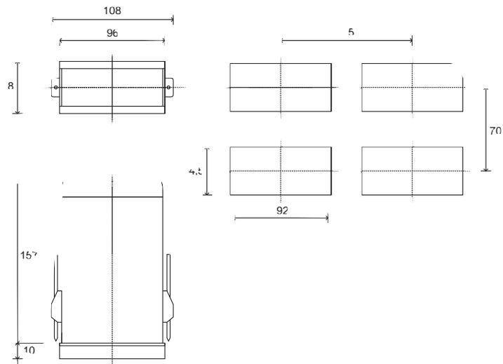
Dimensões: 96x48mm (1/8 DIN), profundidade 157mm.
