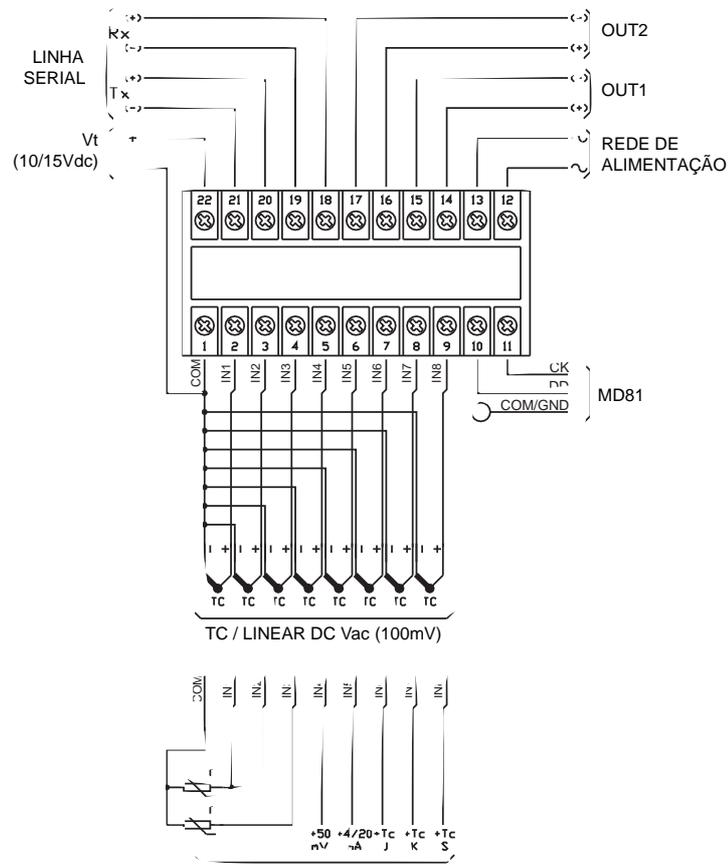
ENTRADAS HETEROGÊNEAS: RTDs de 3-fios precisam de 2 entradas: "main input" ímpar (1-3-5-7) e da entrada par seguinte para compensação do terceiro fio.
