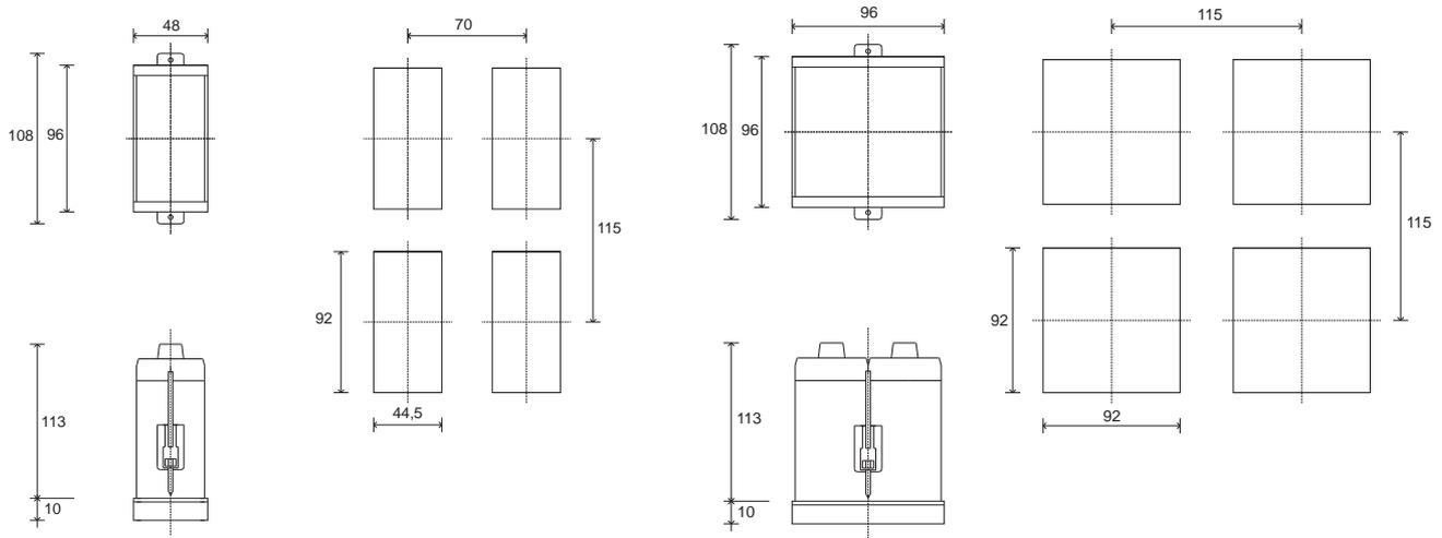
Dimensões: 48x96mm - 96x96mm (1/8DIN - 1/4DIN), profundidade 113mm
